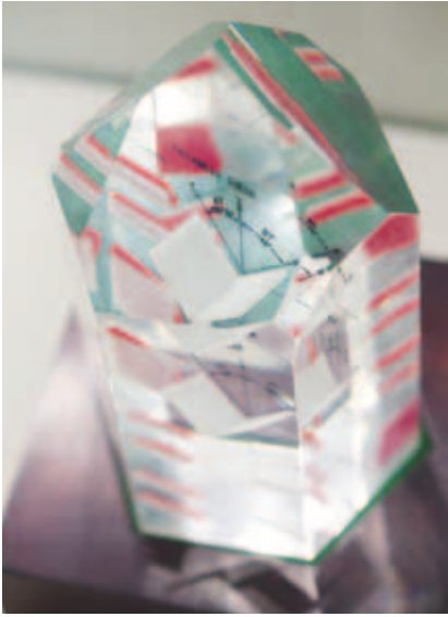
水晶振動子の切り出し模型 Quartz Crystal Oscillator Model
