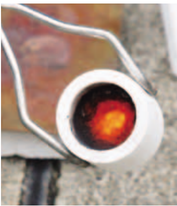
日本古来の製鉄法である たたら製鉄による和鉄の製造実験 Experiment of Traditional Tatara Iron-Making Process
